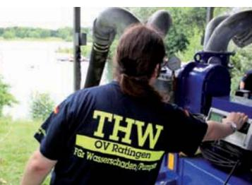
In Vorbereitung auf den THW-Aktionstag am Grünen See am Sonntag, 24. Juni 2012 wurden zwei Wasserentnahme-Arten geübt. Zum einen die direkte Entnahme mittels der Börger-Pumpe des THW über eine Ansaughöhe von rund sieben Metern, zum anderen ein Pufferbetrieb, bei dem ein Becken mit 3.000 Litern Fassungsvermögen mit mehreren Tauchpumpen kontinuierlich mit Wasser gefüllt und mit der Börger-Pumpe der Feuerwehr entleert wird. Besonderes Augenmerk lag
